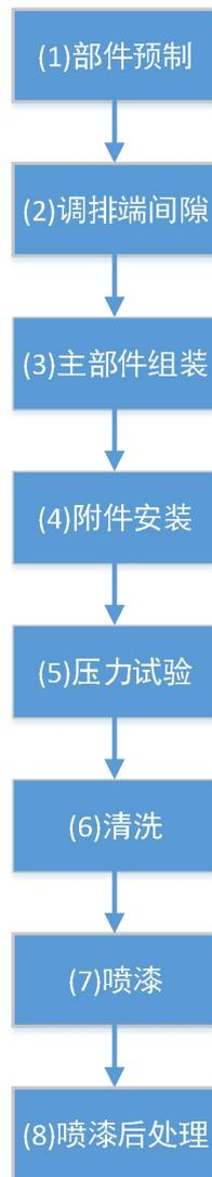
图 1.3 压缩机装配工艺流程图
