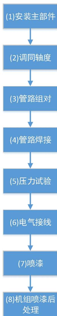
图 1.5 机组装配生产工艺流程图
