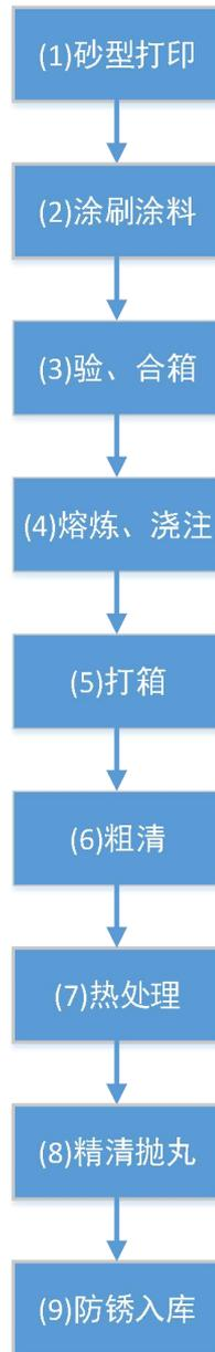
图 1.1 壳体铸造生产工艺流程图
