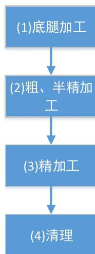
图 1.2 壳体加工生产工艺流程图
